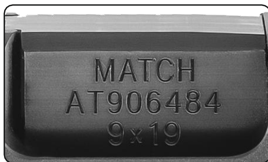
Zdjęcie 9 – Oznaczenie kalibru „9x19” na lufie.
