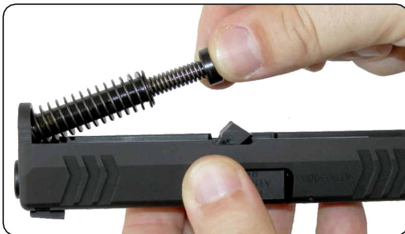
Zdjęcie 20 - Wyjmowanie sprężyny powrotnej
