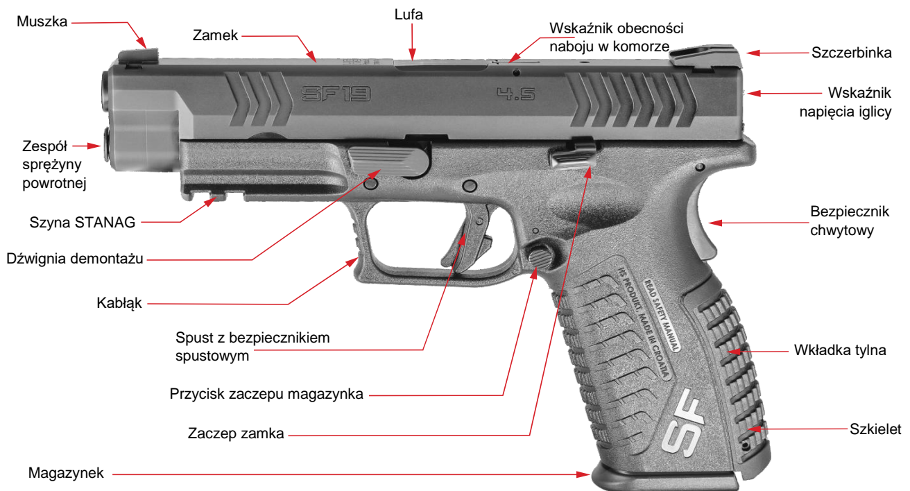
Zdjęcie 1 – Pistolet SF19 4,5” – podstawowa budowa
