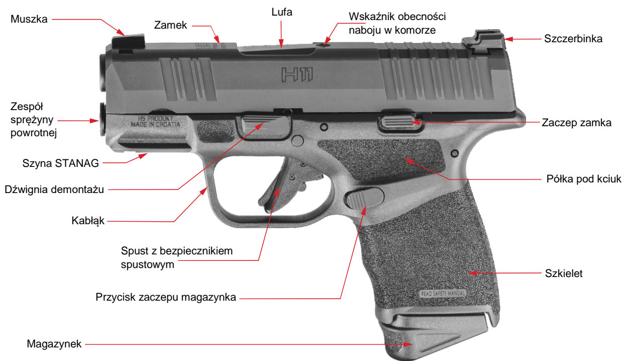
Zdjęcie 3 – Pistolet H11 – podstawowa budowa
